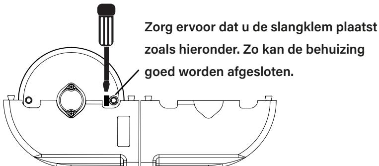
**STAP 5.** Bevestig de warmwaterslang aan de bovenste aansluiting van uw boiler (nummer 2 op de tekening). Gebruik een platte schroevendraaier en één van de meegeleverde slangklemmen.
